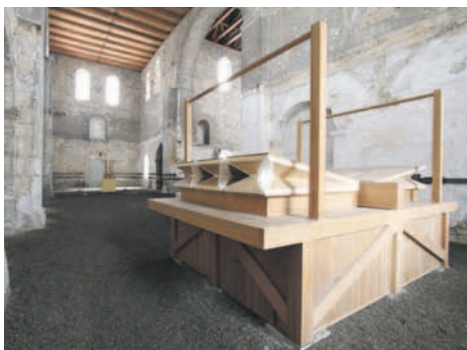
Dauerwind für die Orgel: Die sechs Bälge werden abwechselnd von zwei Gebläsemotoren betrieben.
