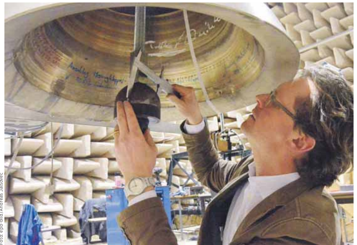
Kulturgut Glocken: Mit einer Schiebellehre vermisst Michael Plitzner, Geschäftsführer des Kompetenzzentrums für Glocken an der Hochschule Kempten, den Durchmesser der Kugel am Ende eines Glockenkloppels.
