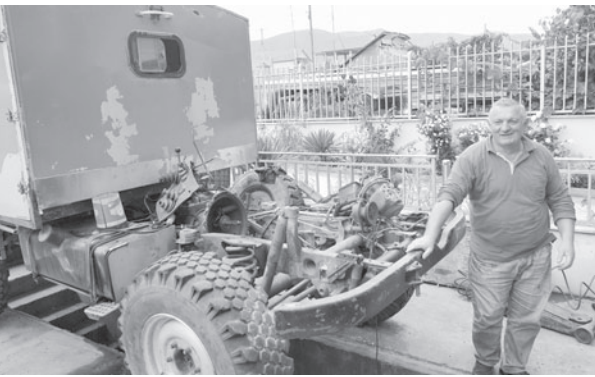
Unser Unimog brauchte im Herbst 2016 eine neue Kupplung, eine aufwändige Reparatur
