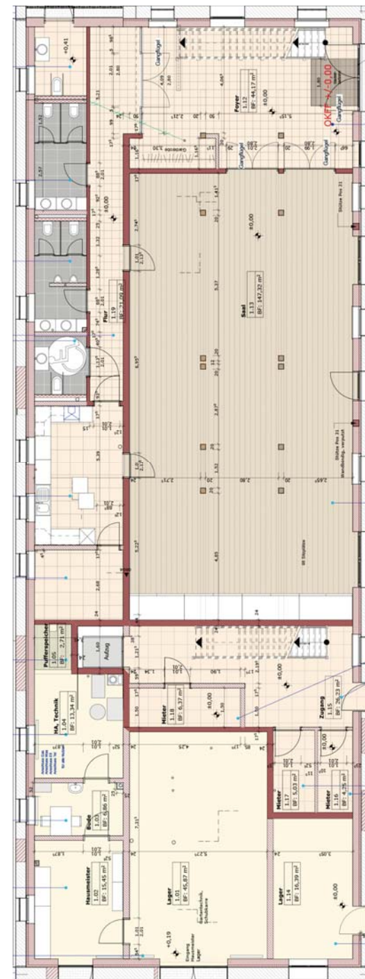
Untergeschoss der Scheune nach dem Umbau
